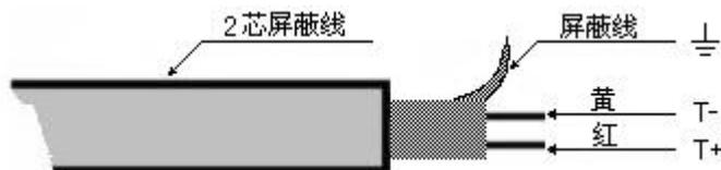
红色芯线接 Sensor1 或 Sensor2 的 T+ 端，黄色芯线接相邻的 T- 端，屏蔽线接  $\perp$ ，探头部分接线与之对应连接；
